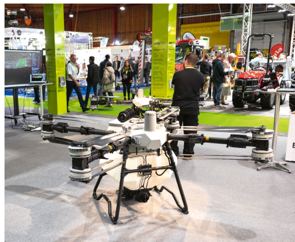
Drohne DJI Agras T25P mit einem maximalen Abfluggewicht von 60 kg
