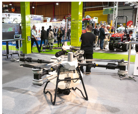
Drone DJI Agras T25P avec un poids maximal au décollage de 60 kg
