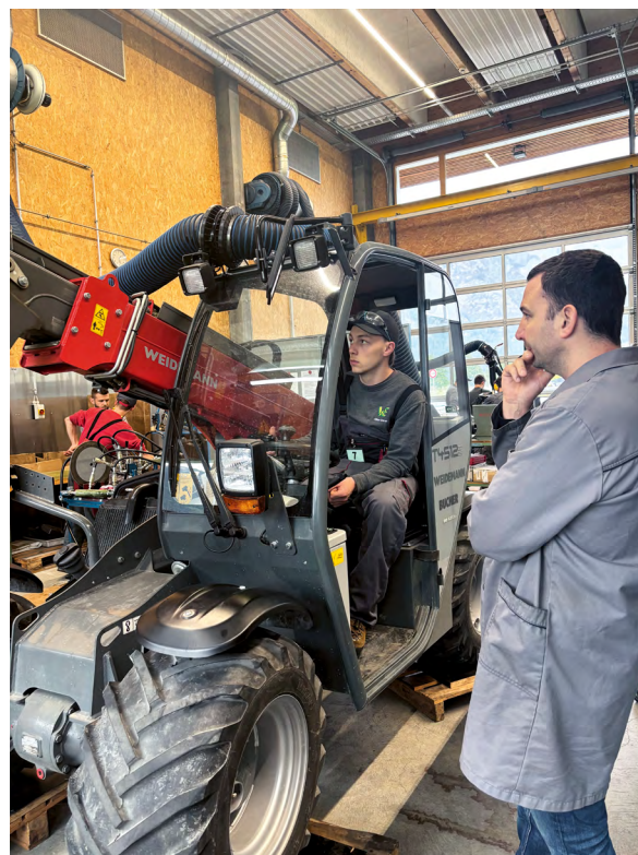
Julian Grimm et l'expert Natan Bigger au poste «Hydraulique». Contrôle du fonctionnement du système hydraulique du chargeur télescopique.
